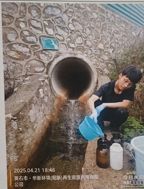
雨水排放口采样点★1
