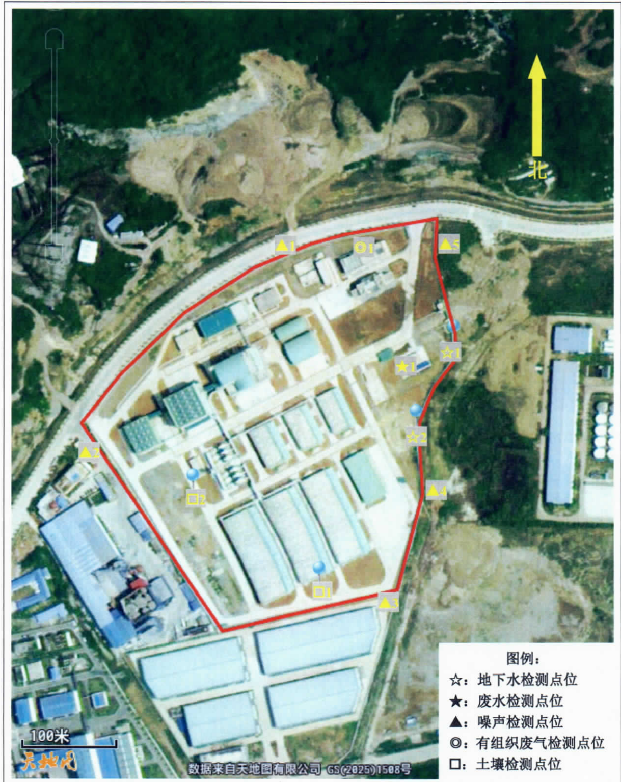
附图 1：现场检测点位平面布置图
