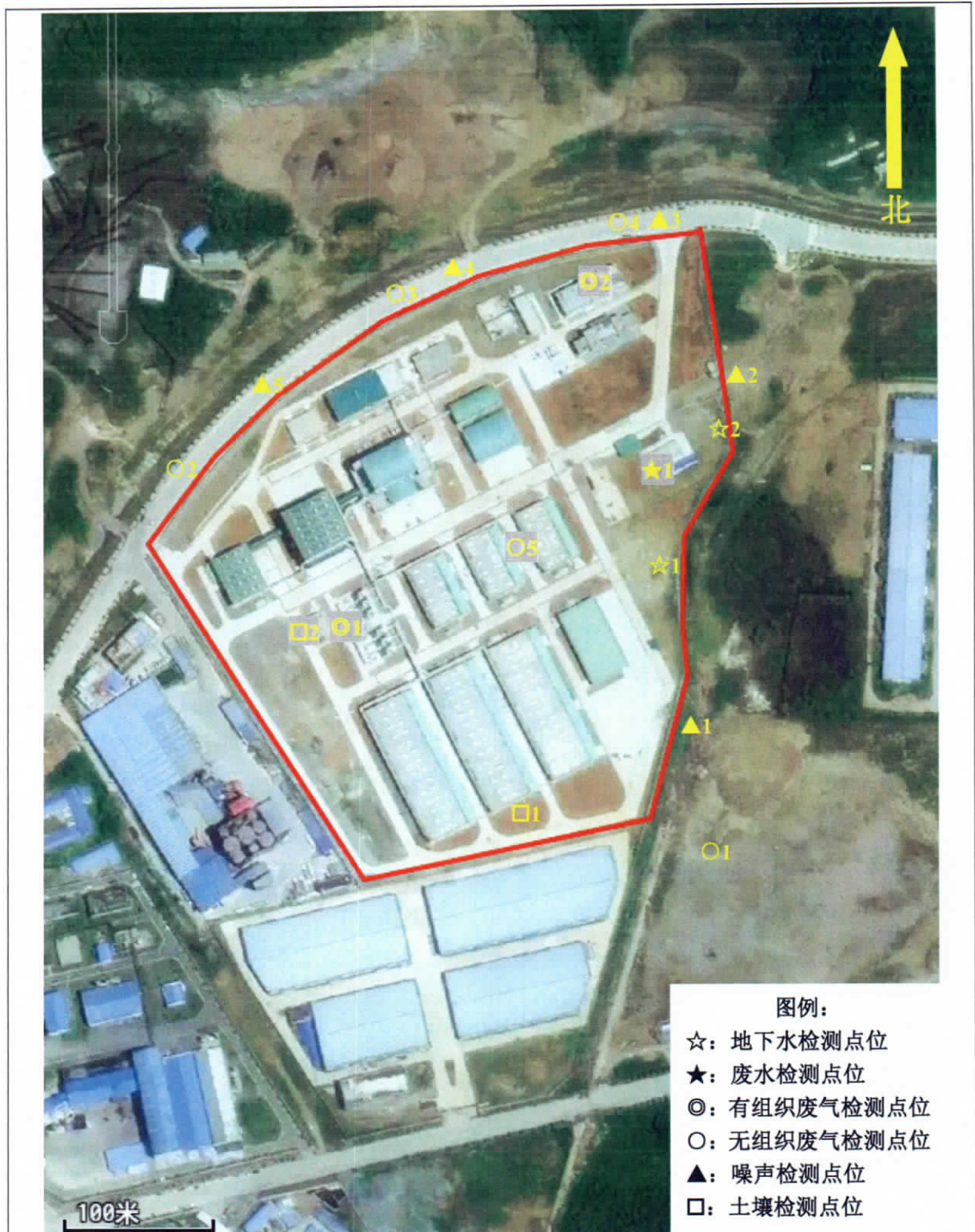
附图 1：现场检测点位平面布置图
